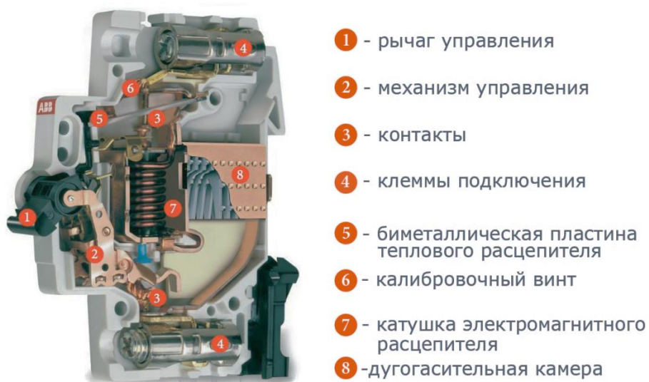
Рис. 1 – Устройство автоматического выключателя
