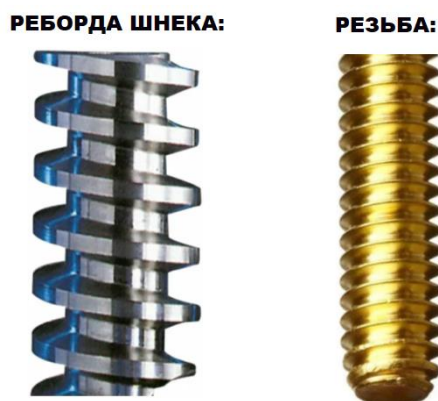
Рис. 3 – Реборда шнека, схожесть с резьбой
