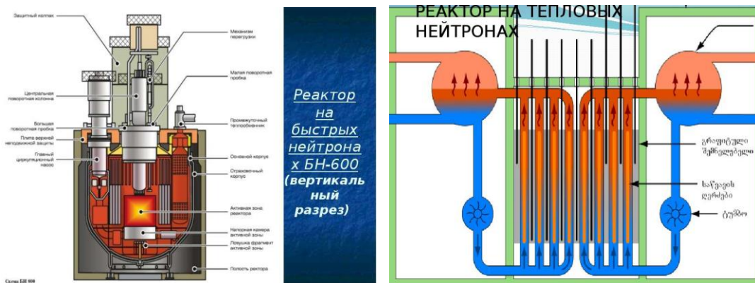
Рис. 1 - Реактор на быстрых и тепловых нейтронах
