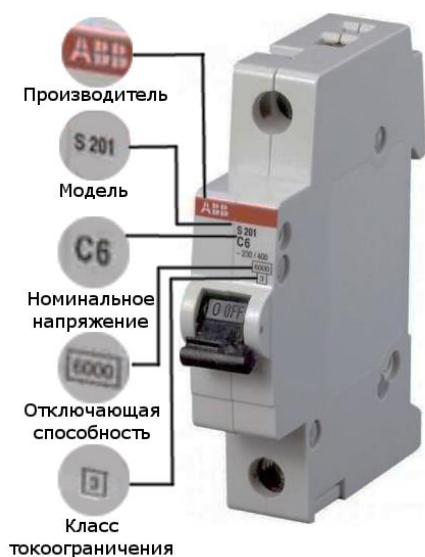
Рис. 2 – Маркировки и их расшифровка на корпусе модульного автоматического выключателя
