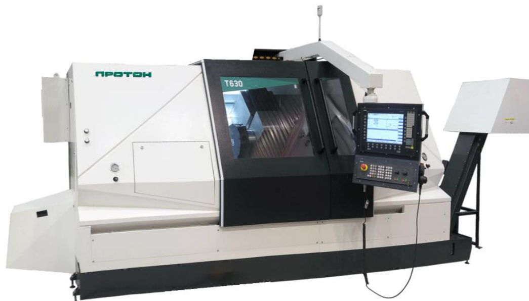
Рис. 3 – Токарно-фрезерный обрабатывающий центр с ЧПУ ПРОТОН Т630
