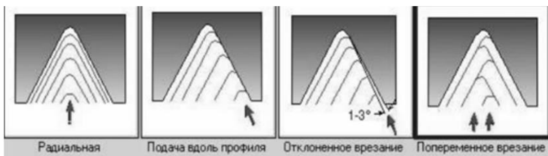
Рис. 6 – Выбор способа врезания резца
